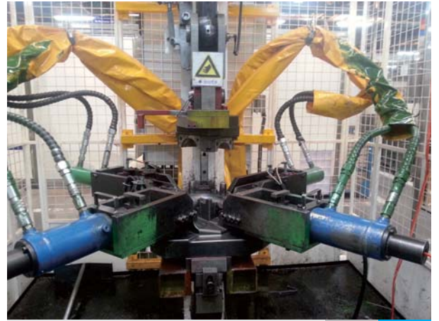
汽车排气管折弯机上17系列电子尺
