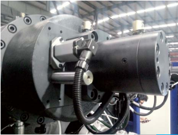
两板注塑机高压缸用上12系列电子尺
