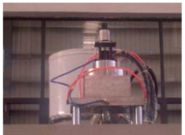
壁厚度控制器用上12系列电子尺
