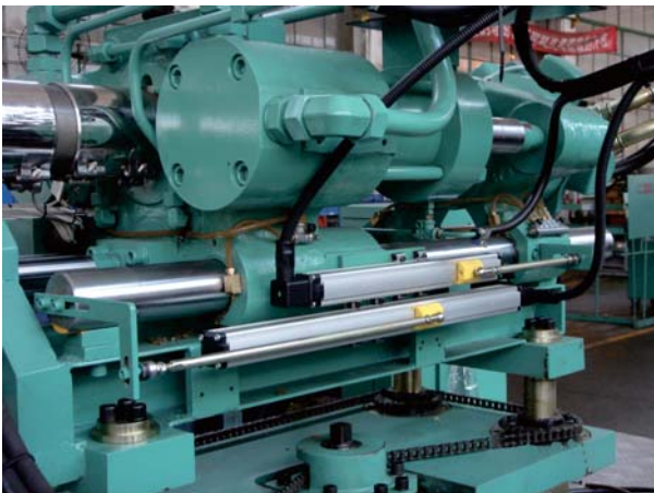
双色机第二次注射台
