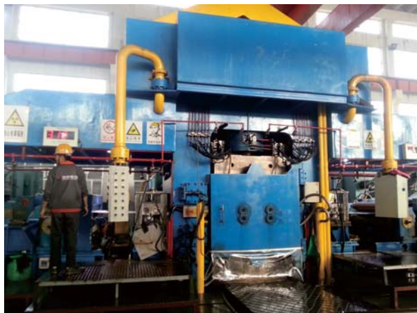
不锈钢压延机用上19系列电子尺
