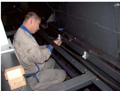
6600吨两板注塑机, 配置7600mm数码电子尺现场安装
