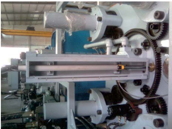
压铸机可以达到每秒10米的注射速度
