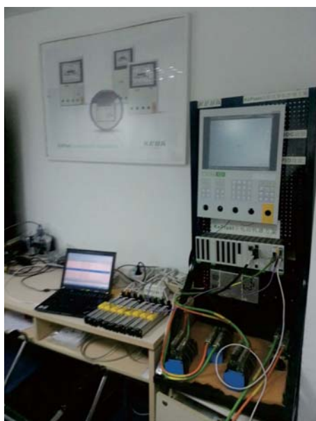
KEBA控制器接数码传感器
